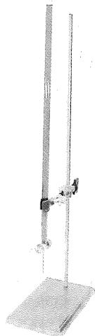
◀ Fig. 2-11. La **bureta** es similar a una pipeta, salvo que tiene un robinete (llave que permite o no el pasaje de un líquido al vástago) y un vástago que permiten retener el líquido y descargarlo, si es preciso, gota a gota.
